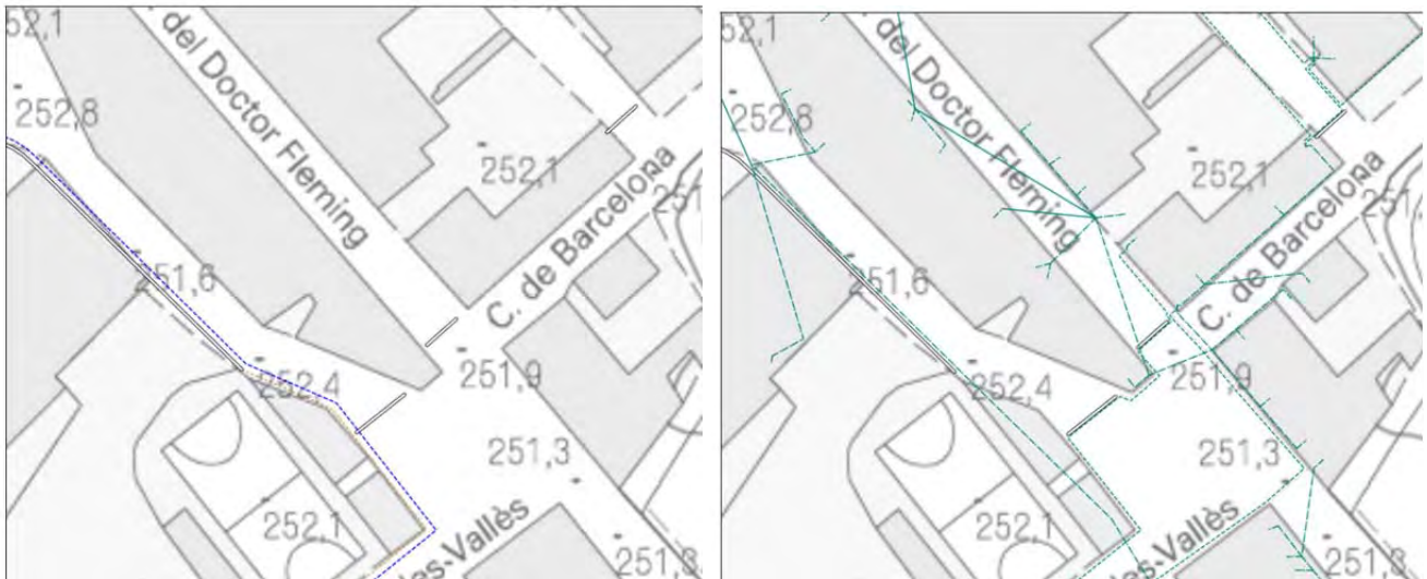
Font: e-distribució. Imatge dreta línies BT aèries, imatge esquerra línies MT soterrades
