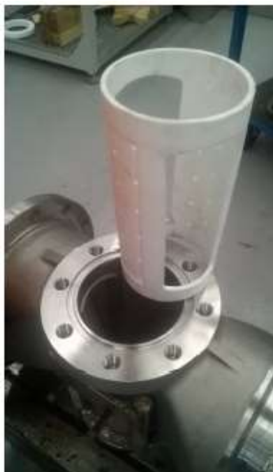
Exemple de camisa de tefló per vàlvula mascle flushing
