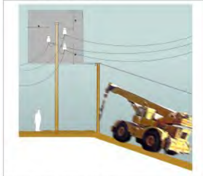
Esquema de pas per sota de línies aèries de Baixa Tensió a=2.00m.
