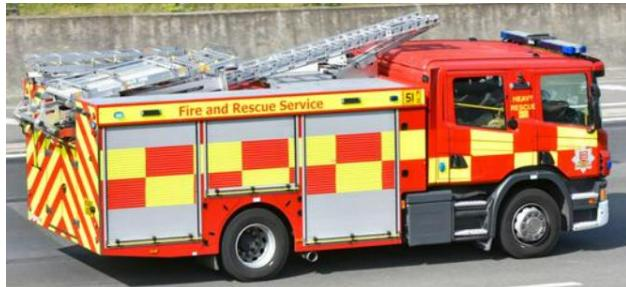
En los laterales de la carrocería, y a una altura adecuada (que se determinará en el proyecto ejecutivo en fase de diseño), se colocará una banda reflectante, en toda la longitud del vehículo, con patrón Battenburg Amarillo RAL1016 retro reflectante / Rojo RAL3026 retro reflectante. Las dimensiones, en cuanto a tamaño de cuadro, también se determinarán en proyecto ejecutivo.
