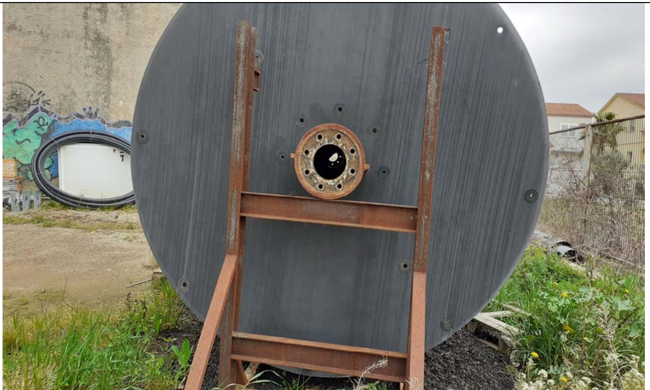
Foto 5. . Biodiscs malmesos acopiats fora del reactor biològic
