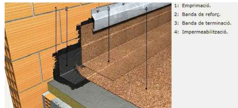
Detall trobada de coberta amb perímetre (mín. 20cm alçada)
