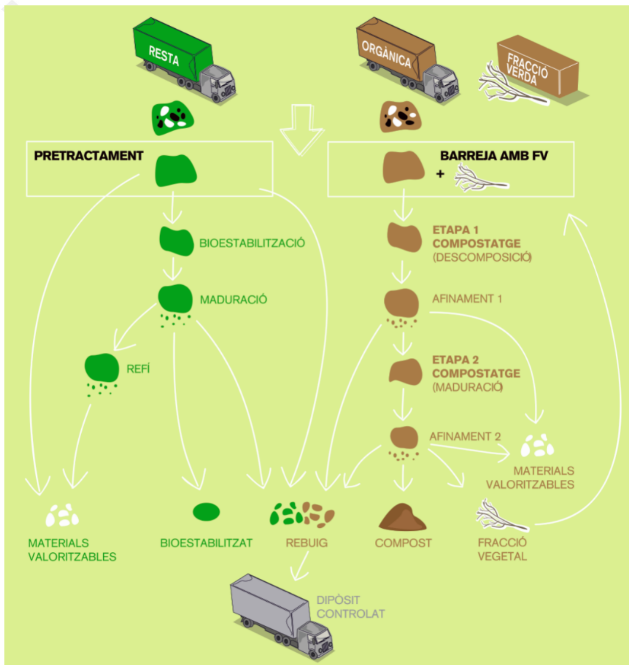
Imatge 2. Infografia dels processos de les plantes de tractament del CTRAE.
