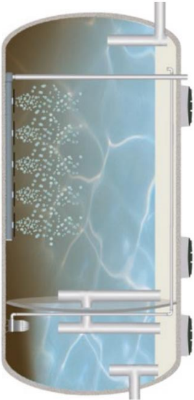
REACTOR BIOLÒGIC CLARIFICADOR Figura 6: Esquema d'aeració prolongada.
