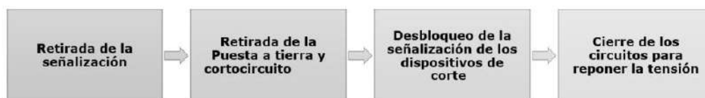
Figura 9. Pasos para trabajar sin tensión y restauración (Instrucción TERSA IESFV)
