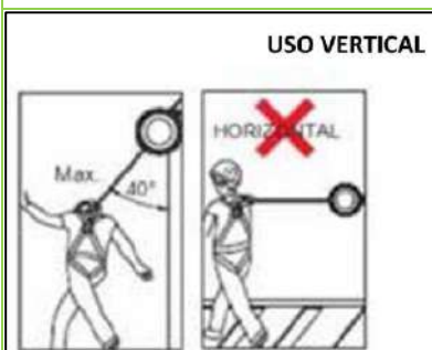
Figura 7. Ejemplo posicionamiento incorrecto dispositivo retráctil
