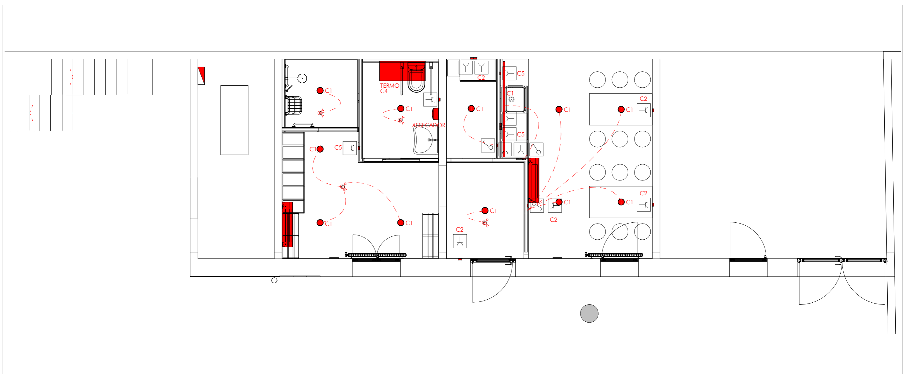
PROP-PLANTA BAIXA - ELECTRICITAT / 1 : 50
