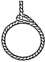
Mal - El ajuste de ojal corta el cable en movimiento.
