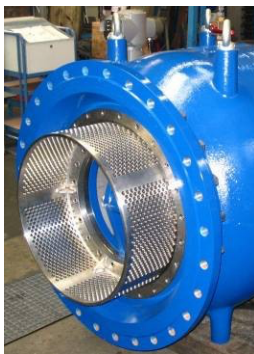
Cilindre perforat en posició tancada (el cilindre surt al exterior)
