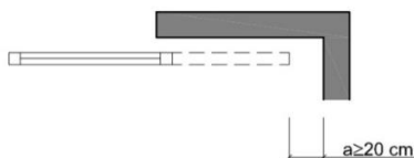
Figura 2.1 Holgura para evitar atrapamientos
