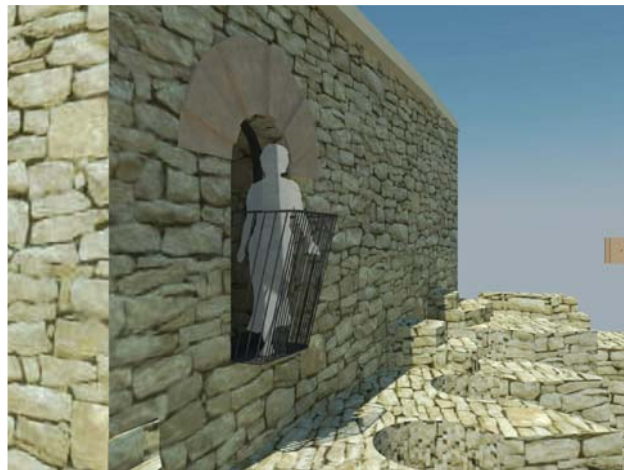
ALÇAT FRONTAL PROPOSTA ACTUACIÓ. ÀMBIT ÀMBIT BALCÓ SORTIDA SOBRE ESPERONS CUPS. ESCALA 1/50
