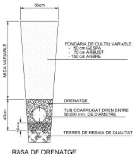
Taula 28.- Secció transversal rasa de drenatge
