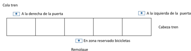
Figura 52. Diagrama dels cotxes en un tren de la sèrie 5000 i ubicació dels beacons.
