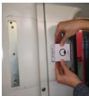
Figura 50. Instal·lació de beacon dins de panell informatiu (II).
