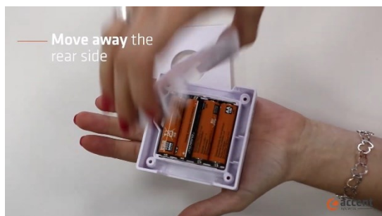
Figura 83. Treure la part posterior.
