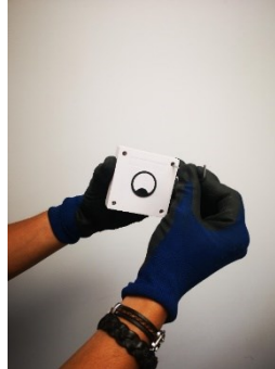
Figura 13. Retirant els 4 cargols.
