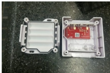
Figura 15. Detall del marc de fixació i del bloc principal del beacon.
