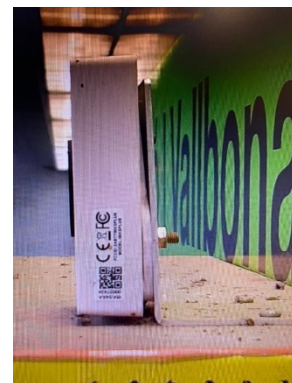
Figura 20. Instal·lació de beacon amb element de fixació (resultat).
