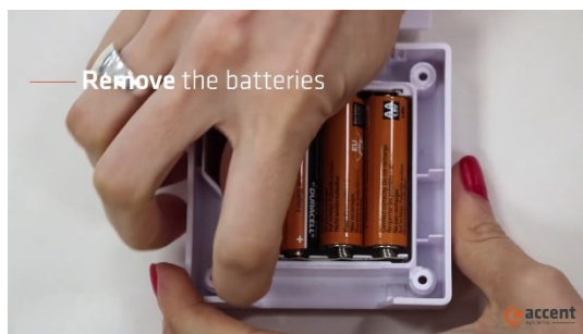
Figura 84. Treure les bateries.
