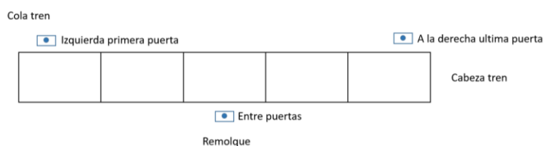
Figura 37. Diagrama dels cotxes en un tren model 2100 i ubicació dels beacons.
