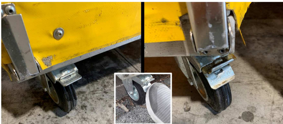
Figura 3. Rodes del kit de transport. Esquerre, fre desactivat. Dreta, fre activat
