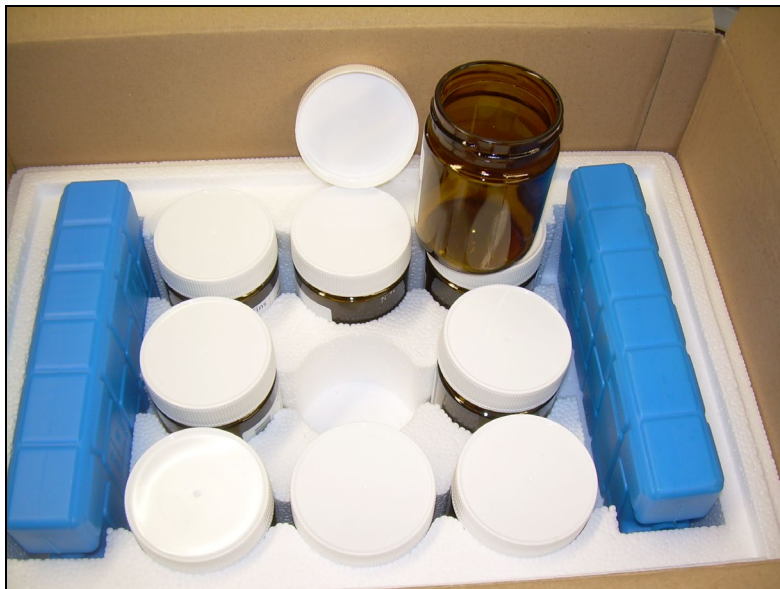
Figura 1: Espai refrigerat per a la conservació de les mostres
