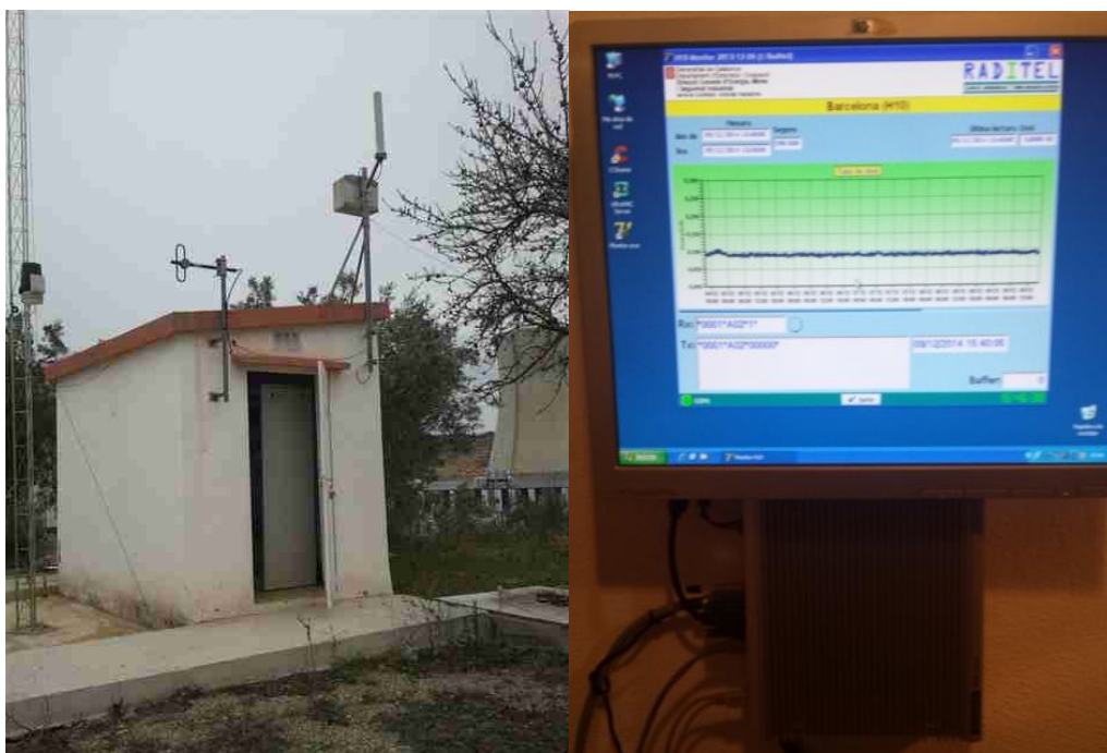
Detall d'un equip de la xarxa X10 amb triple sonda Geiger (1)
