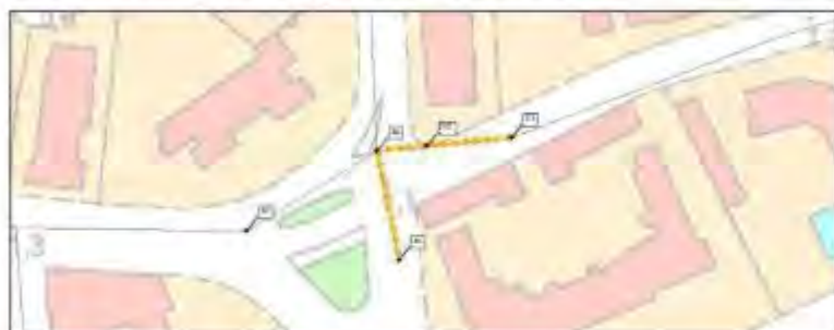
Figura 71. Actuació 2.7. Reposició dels col·lectors amb mànega
