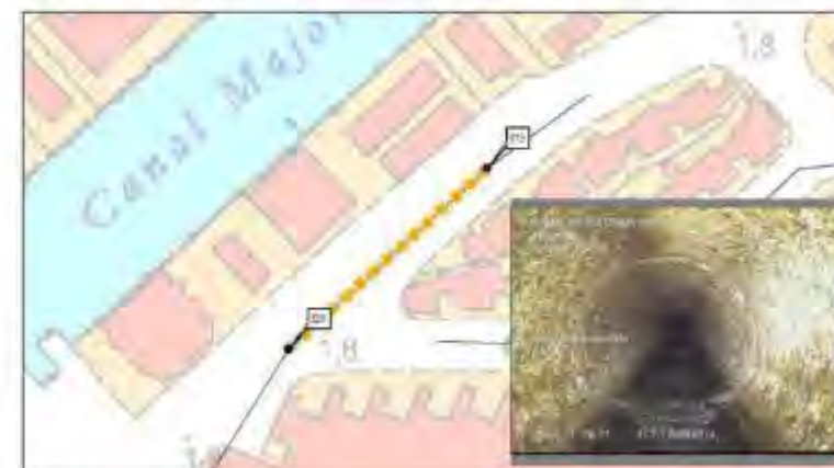
Figura 39: Col·lector de formigó erosionat i amb juntes amb espaïament 819 – 820
