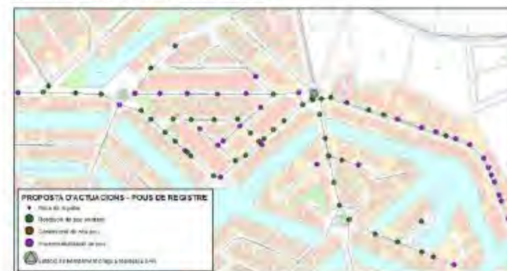
Figura 79: Actuacions per a la reposició i impermeabilització de pous de registre
