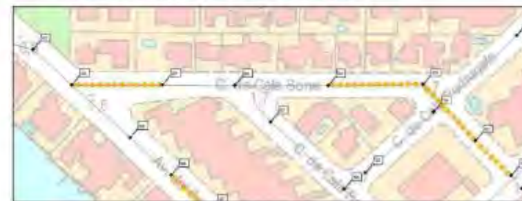
Figura 44: Actuació 2.2. Reposició dels col·lectors amb mànega entre els pous de registre 802 - 824
