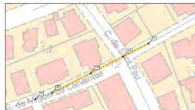
Figura 74. Actuació 2.8. Reposició dels col·lectors amb mànega
