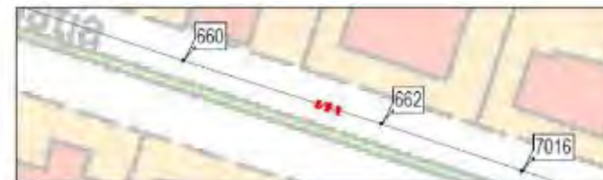
Figura 31: Actuació 1.5. Reposició del col·lector entre els pous de registre 662 - 660
