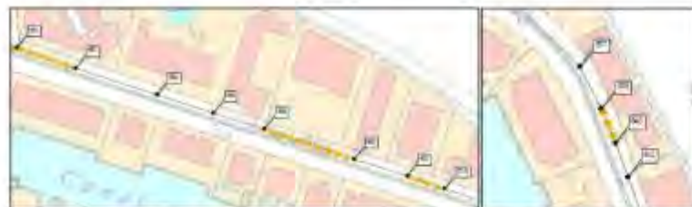
Figura 56. Actuació 2.4. Reposició dels col·lectors amb mànega
