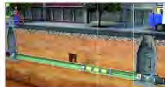
Figura 15: Reparació amb mànega d'un col·lector
