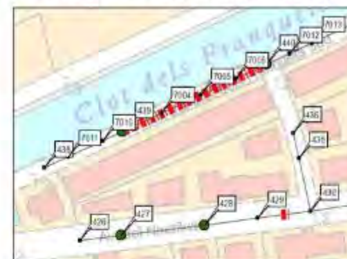
Figura 34: Actuació 1.6. Reposició del col·lector entre els pous de registre 439 – 440 i 429 - 430
