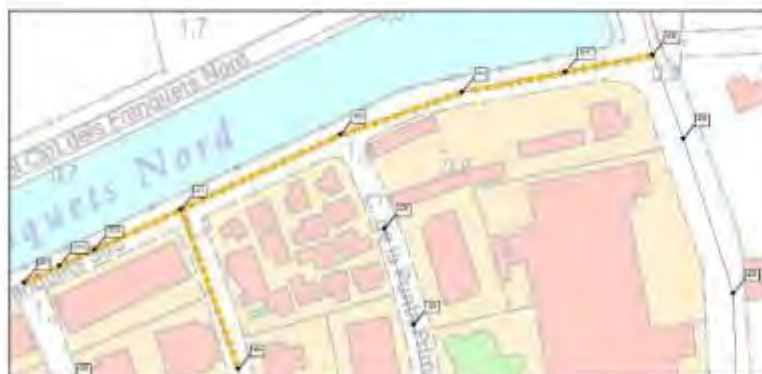
Figura 67: Actuació 2.6. Reposició dels col·lectors amb mànega
