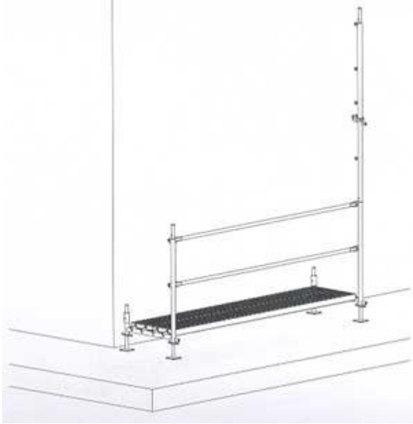
Figura 6 Instalación del marco parcial en L
