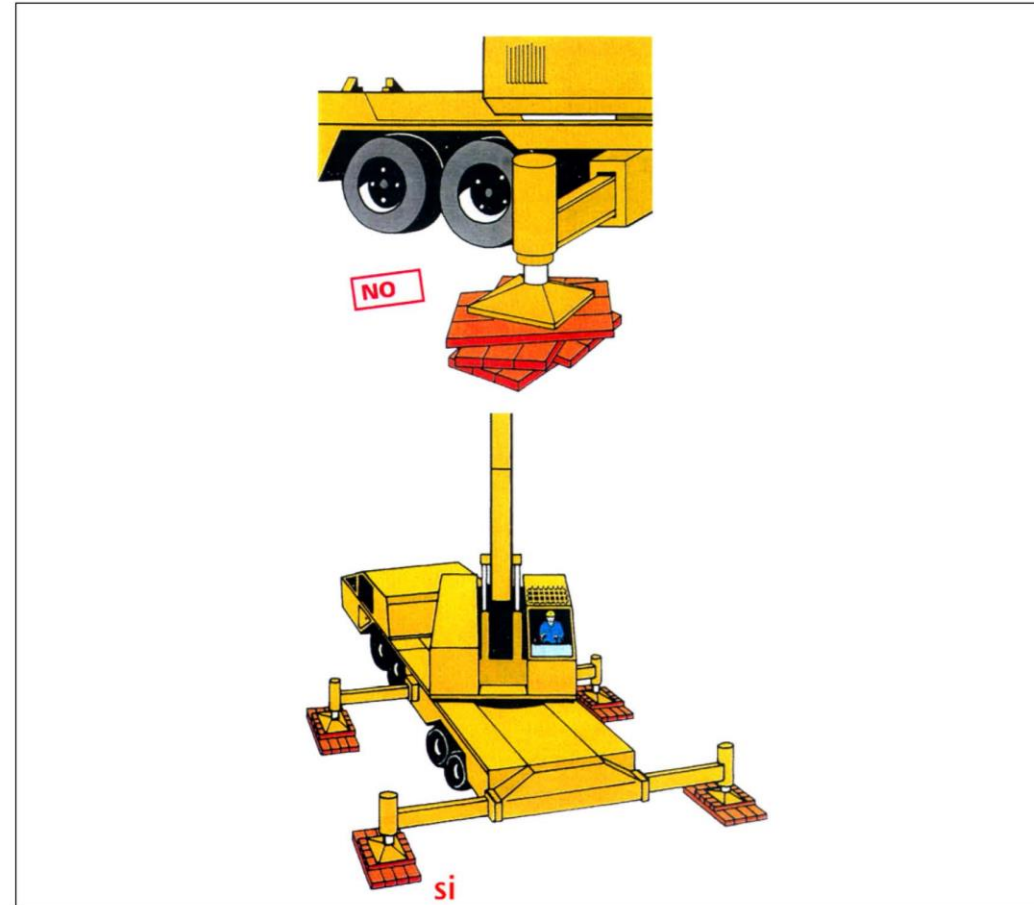
Col·locació estabilitzadors recolçaments
