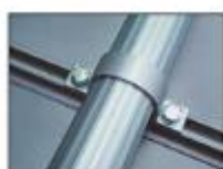
Conjunt màstil de 60 mm de diàmetre estriat amb brida tipus omega d'interior estriat per evitar el gir del senyal.
