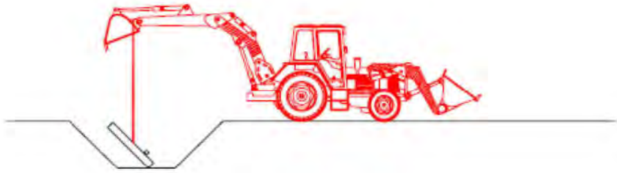
3. Col·locació de la base del pou
