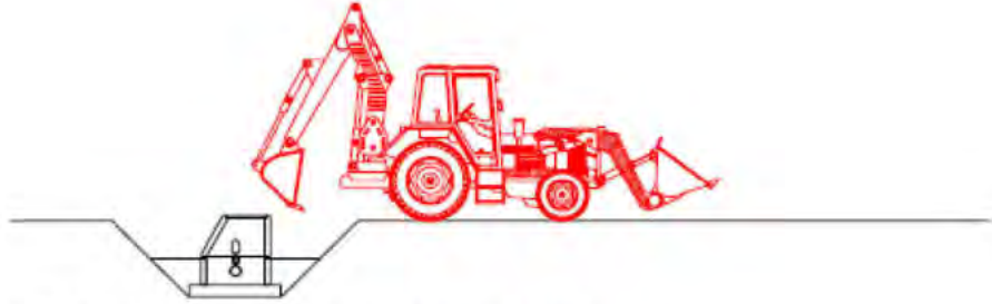
6. Reblert del pou amb retro-excavadora en tongades
