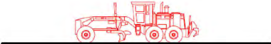
5. Estesa del tot-ú amb motoanivelladora ...
