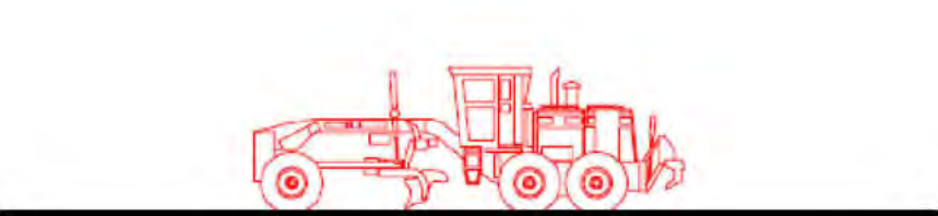
1. Regularització i acondicionament del camí amb motoanivelladora. Neteja i perfilat de les cunetes.
