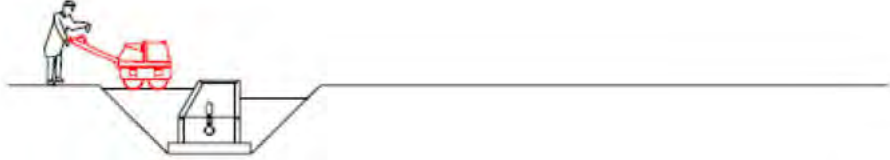
7. Compactació de terres al voltant del pou
