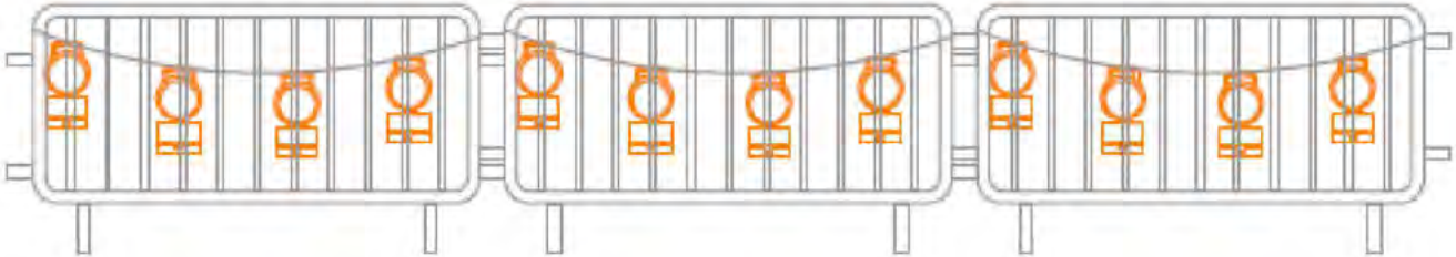
TANCA D'OBRA AMB BALISES PENJADES AMB CÈL·LULES FOTOELÈCTRIQUES
