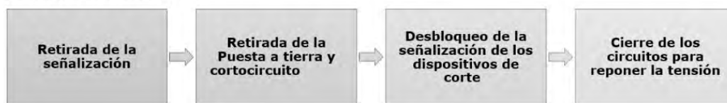
Figura 9. Pasos para trabajar sin tensión y restauración (Instrucción IESFV)
