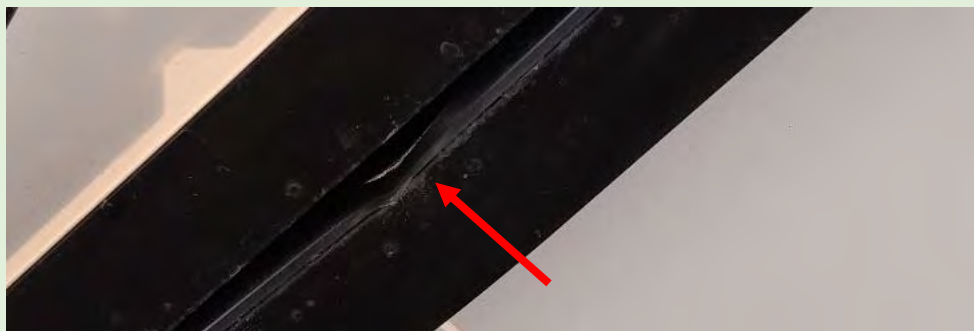
Marc d'un mòdul afectat per un cop al lateral.
