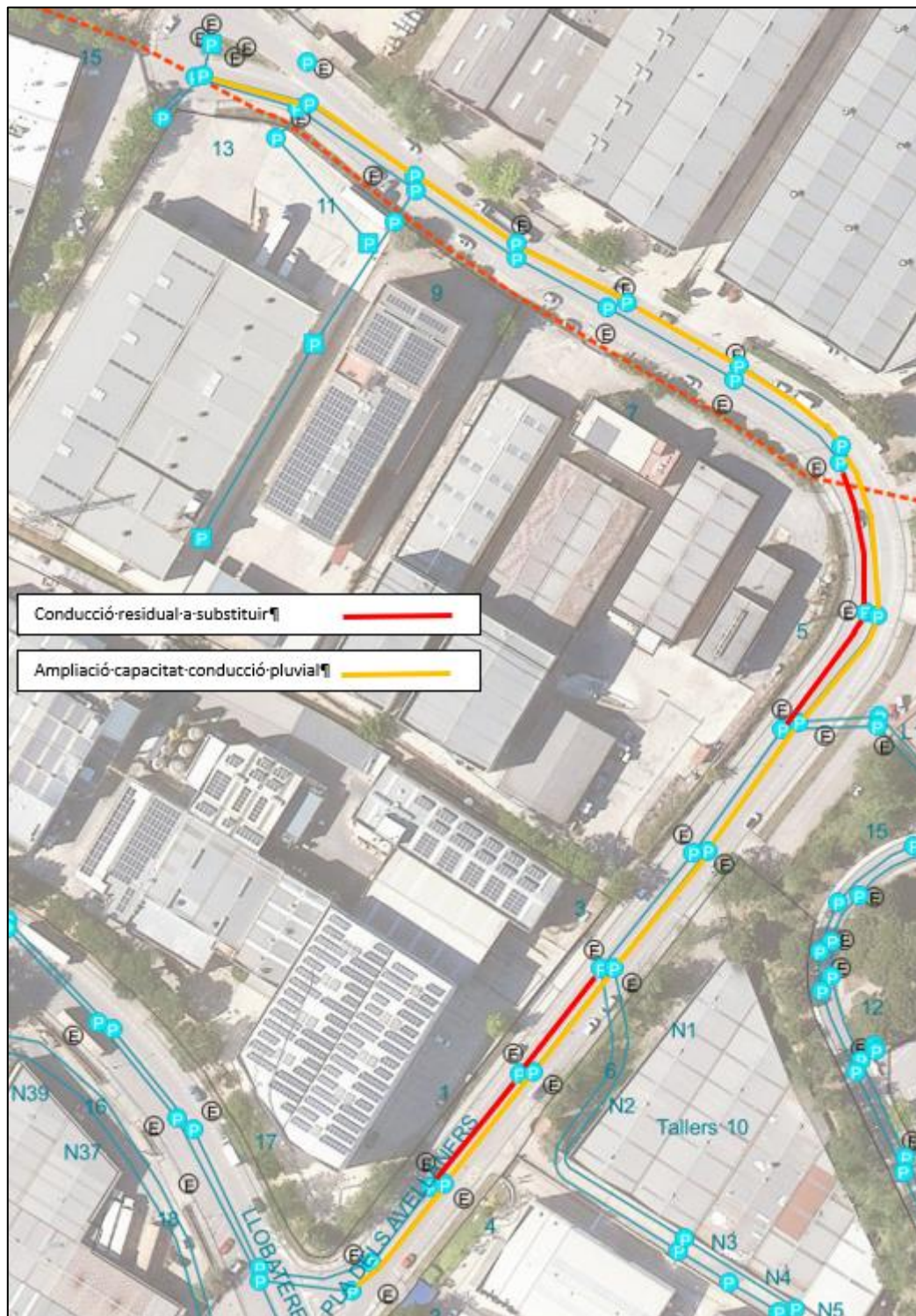
Figura 4. Actuacions a la xarxa separativa de clavegueram del c/ Pla dels Avellaners.
