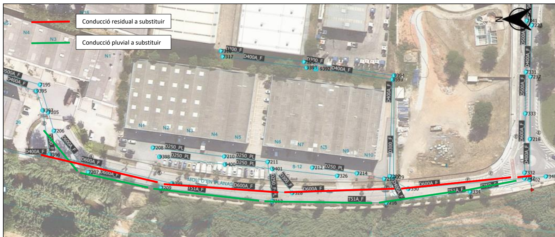
Figura 6. Actuacions a la xarxa separativa de clavegueram al c/ Molí d'en Planas.
