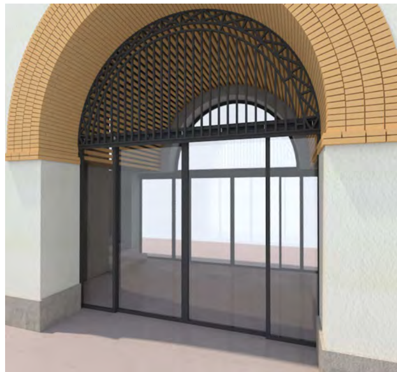
PORTA EXTERIOR FAÇANA PRINCIPAL VISTA 01 Carpinteria d'alumini sense rotura pont tèrmic Color RAL 9011 mate Vidre de seguretat laminat transparent 5+5 mm
