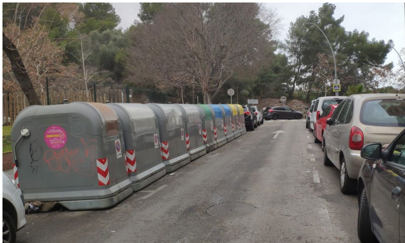
Exemple de perfil de calçada estreta amb vehicles estacionats en banda oposada al contenidor i amb arbre de copa baixa sobre la calçada.
