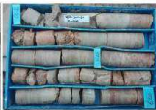
Caixan nº 2: Testimonis extrems del sondeig S-3 compresos entre 3,00 - 6,0 m de fondària.
