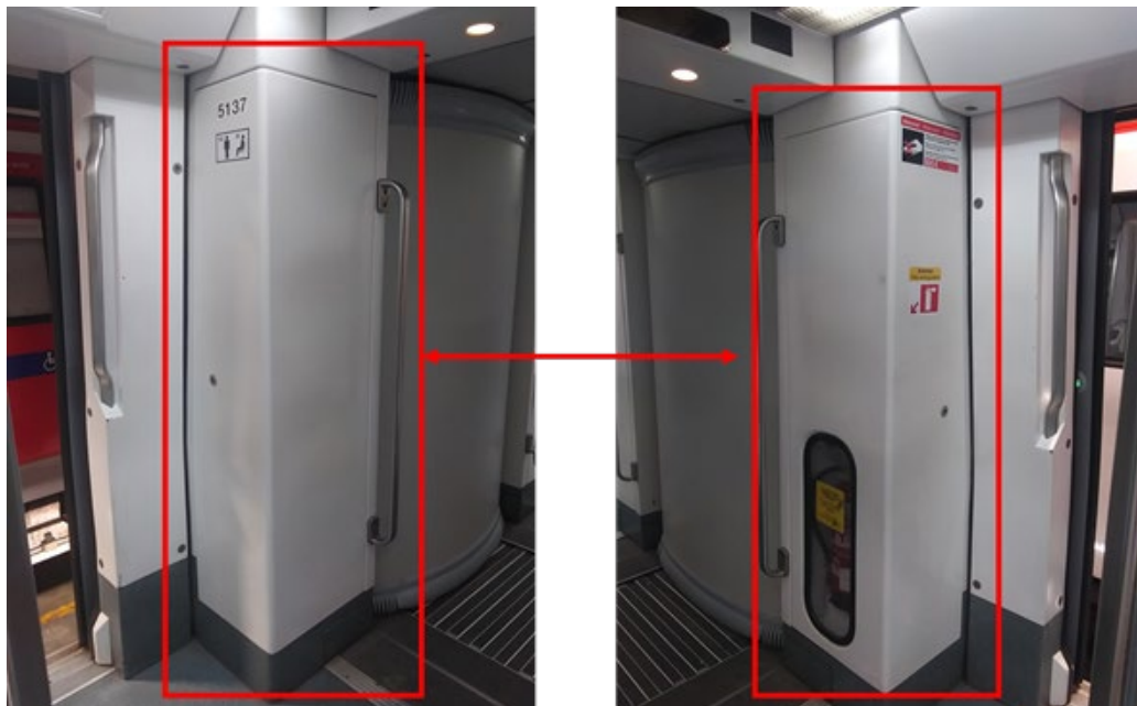
Figura 3.3. Portes d'armari elèctric i extintor S/5000 i S/6000
