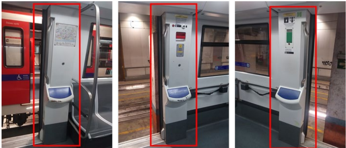
Figura 3.5. Exemples de muntant amb suport isquiàtic (sense res, amb tirador d'alarma i amb desbloqueig)
