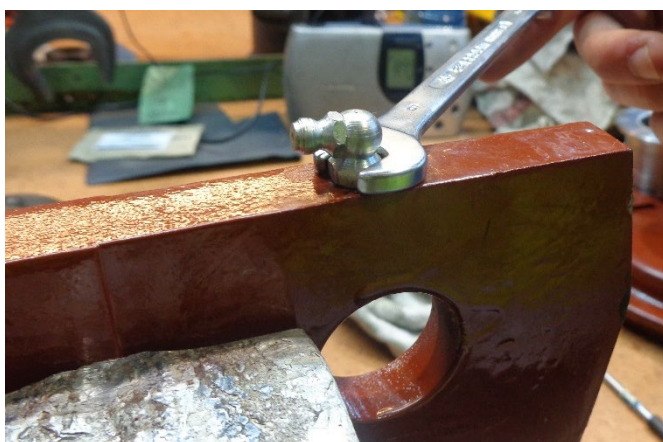
Sustituir engrasador leva
