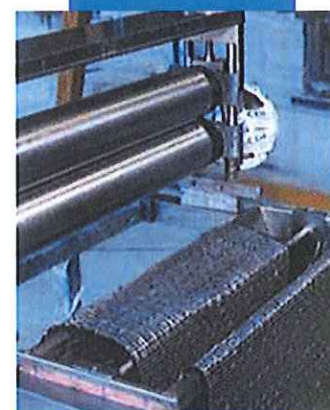
Impregnación con máquina de MapeWrap C
