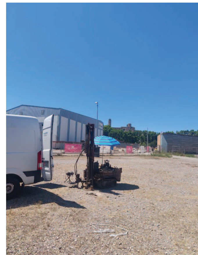
Fotografies de l'emplaçament de l'assaig PD-2 amb una fondària de reconeixement de 6,4 m.
