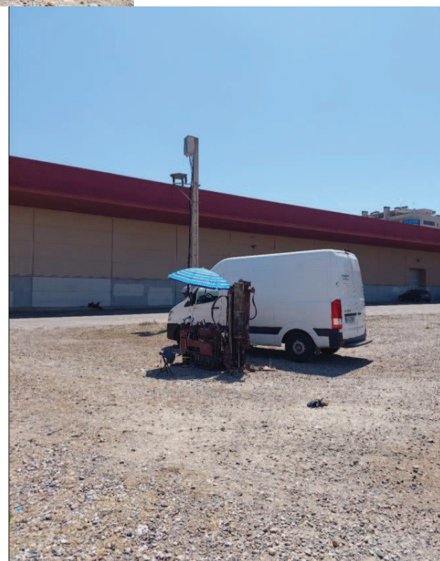
Fotografies de l'emplaçament de l'assaig PD-1 en l'àrea de la planta prevista del projecte. En l'assaig una massa de dimensions normalitzades colpeja el varillatge que es va clavant en el subsòl oferint una resistència a la penetració.
