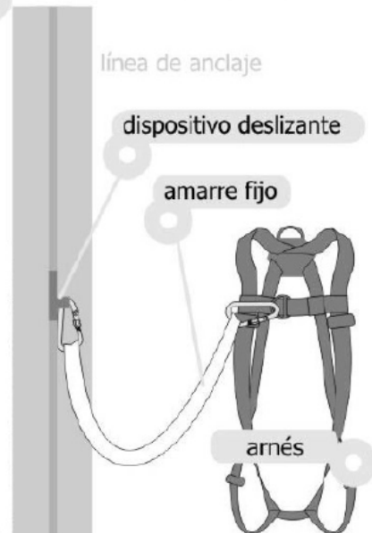
con línea de anclaje rígida
