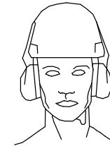
Orelleres acoblades a un casc de protecció per la indústria EN 352-3
