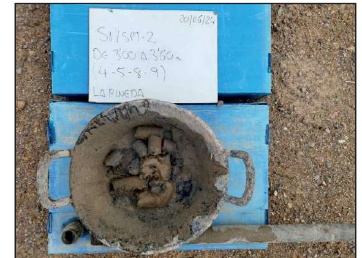
Assaig SPT realitzat entre 3,0 i 3,6 m.
