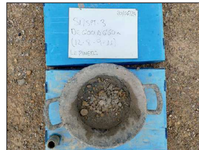
Assaig SPT realitzat entre 6,0 i 6,6 m.
