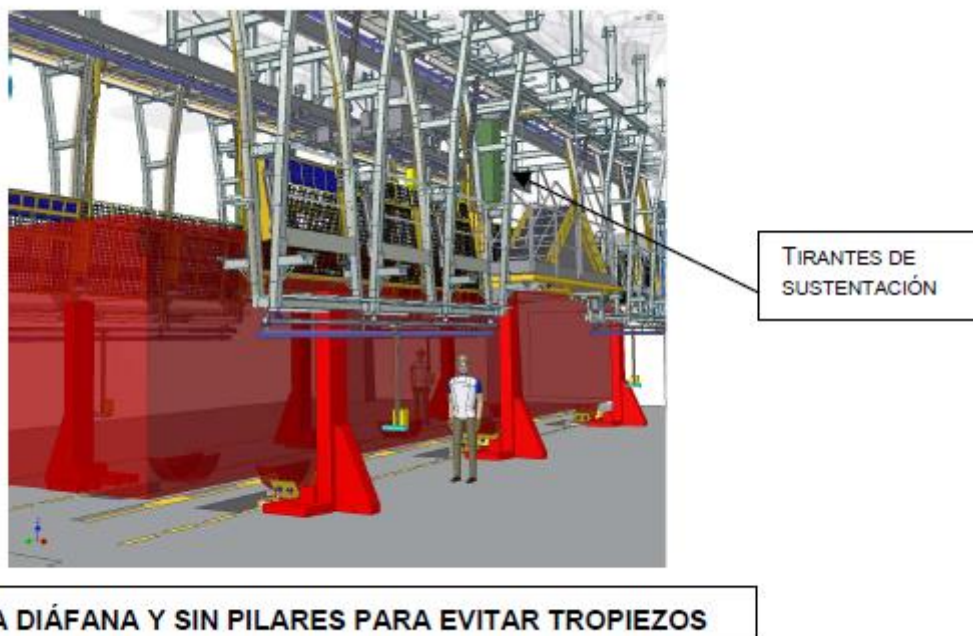
Figura 6 (ejemplo sustentación pasarela cochera Triangle)
