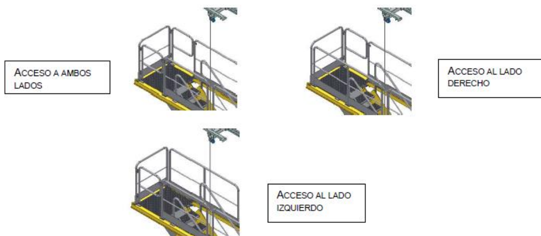
Figura 11 (ejemplo de acceso escalera cochera Triangle)
