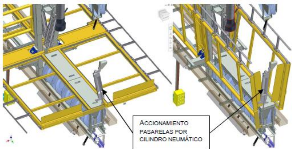
Figura 5 (ejemplo accionamiento pasarela cochera Triangle)
