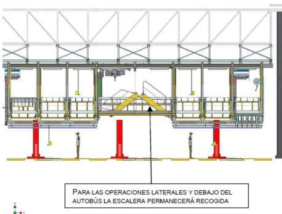
Figura 9 (ejemplo de escalera abatible cochera Triángulo)
