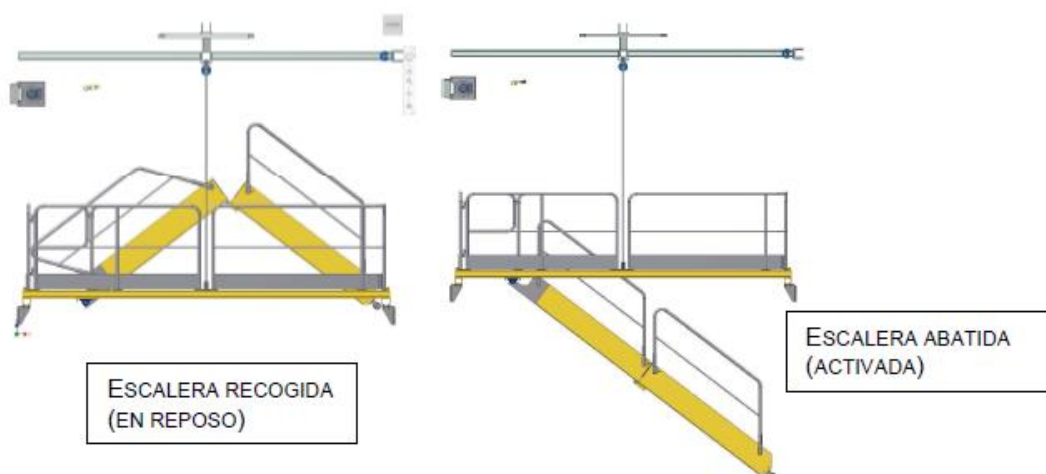
Figura 10 (ejemplo de escalera abatible cochera Triangle)
