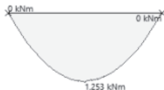
Imatge 27: Moments en l'encofrat, en ELU.
