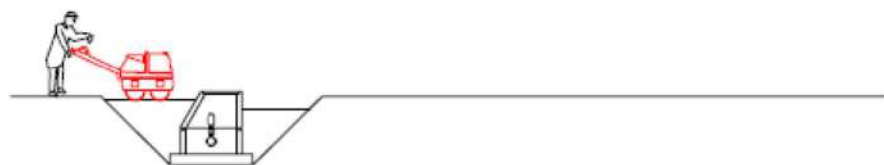
7. Compactació de terres al voltant del pou
