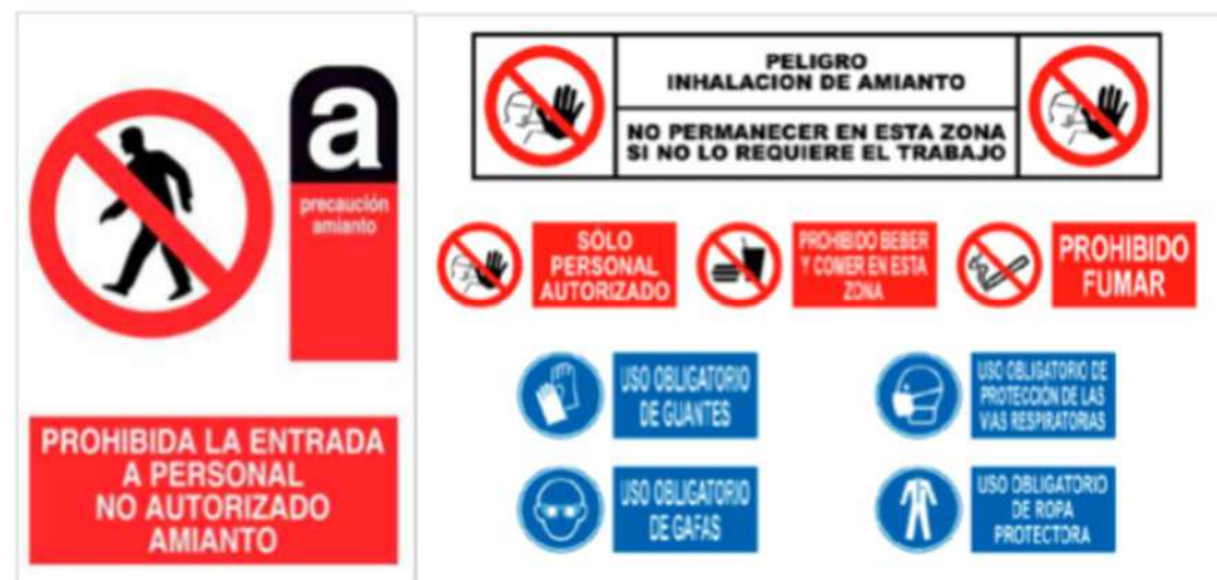
Figura 1: Senyalització necessària a implantar als accessos d'obra
