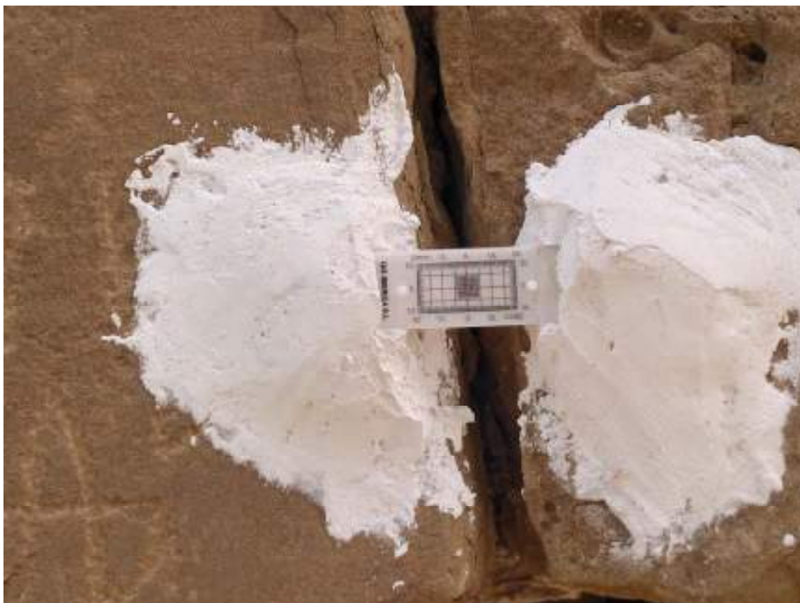
Testimonis de guix i vidre col·locats a l'agost de 2022 (Fotografia del 4 de juliol de 2023)
