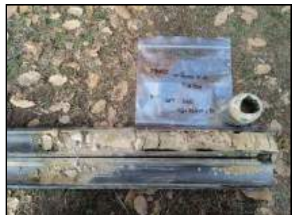
Foto 4: Sondeig S-1, SPT a 5,6 metres.
