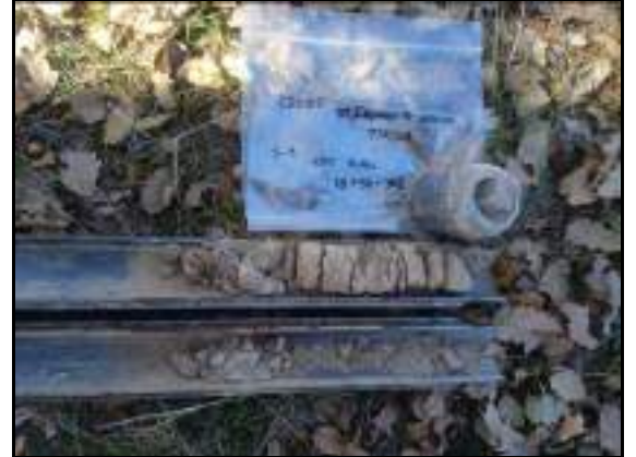
Foto 8: Sondeig S-3, SPT a 0,4 metres.
