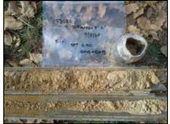
Foto 2: Sondeig S-1, SPT a 0,9 metres.
