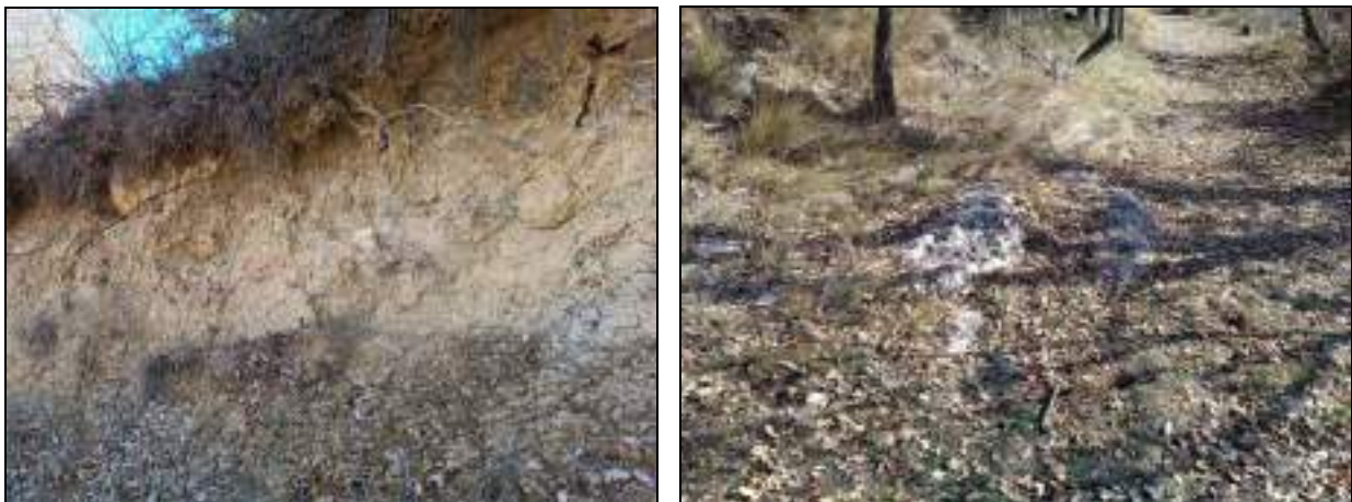
Materials de la capa A en un aflorament proper (esquerra), sota un nivell de sòl vegetal; i materials calcaris de la capa A aflorant en superfície a la zona estudiada (dreta).
