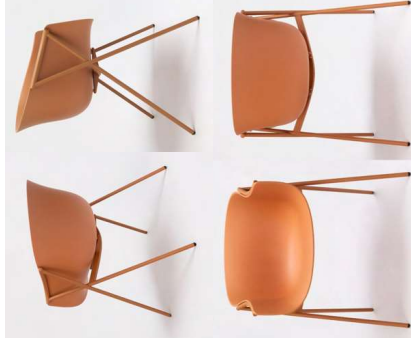
2 Cadira model BAI marca ONDARRETA. Estructura tub de 18mm de diàmetre i 2mm de gruix, pintat en epoxi color Terracota NCS 3040 Y40R.
