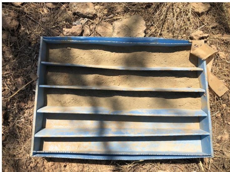
FOTOGRAFIA 9. Sondatge S-02. Caixa 4. De 9,00 m a 10,8 m
