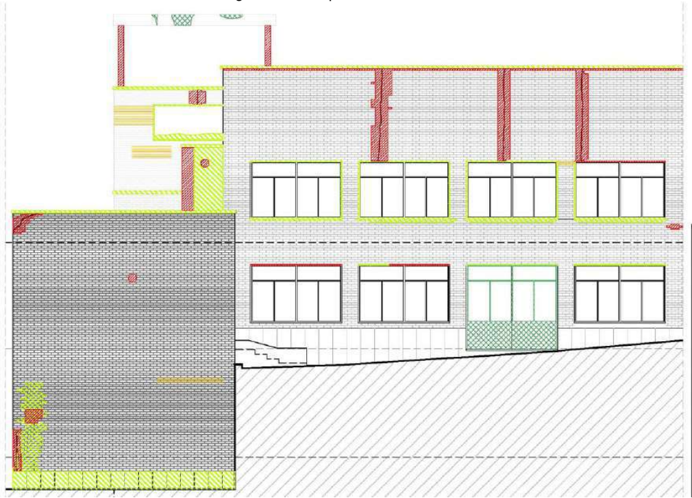
Patologies a l'actual façana nord-oest de l'edifici.
