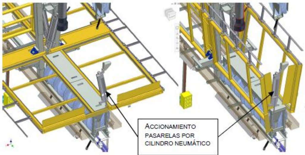
Figura 5 (ejemplo accionamiento pasarela cochera Triangle)
