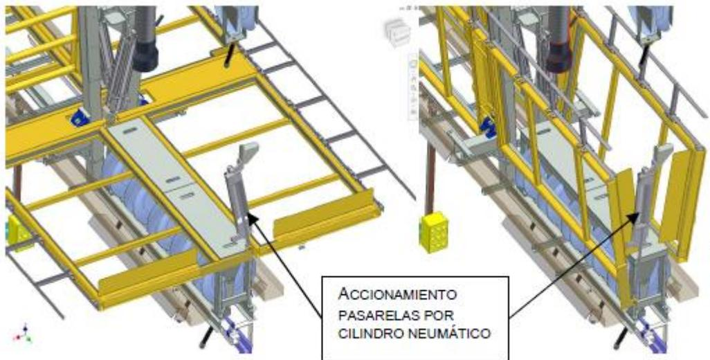
Figura 5 (ejemplo accionamiento pasarela cochera Triangle)
