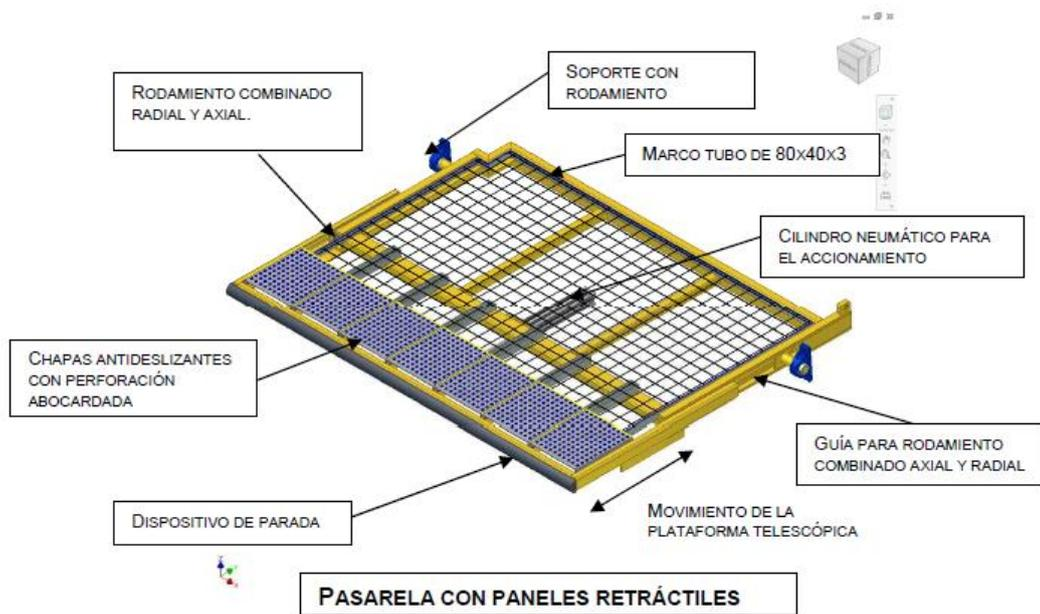
Figura 8 (ejemplo pasarela con panel retráctil cochera Triangle)
