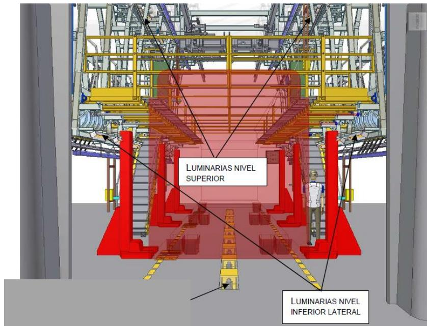
Figura 16 (ejemplo luminarias en cochera Triangle)
