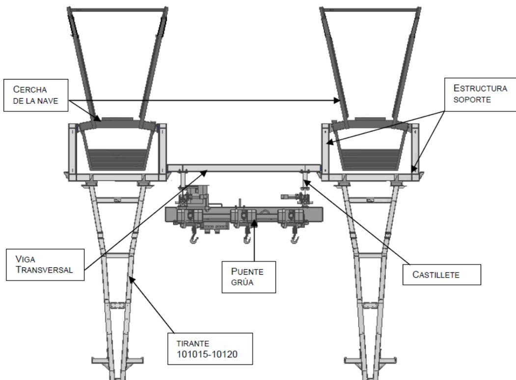
Figura 1 (ejemplo de estructura cochera Triangle)
