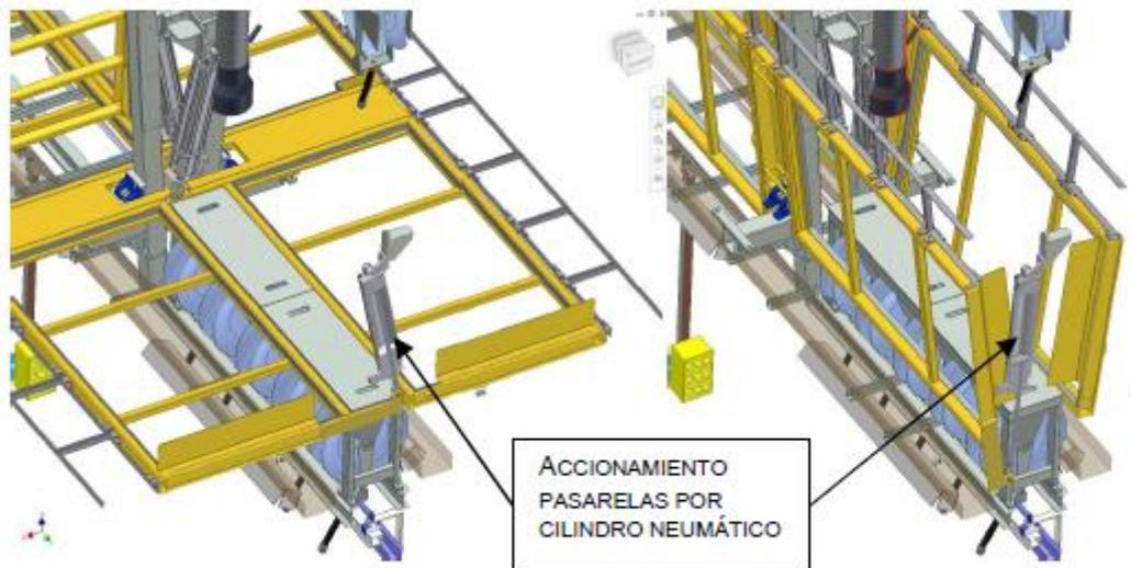
Figura 5 (ejemplo accionamiento pasarela cochera Triangle)
