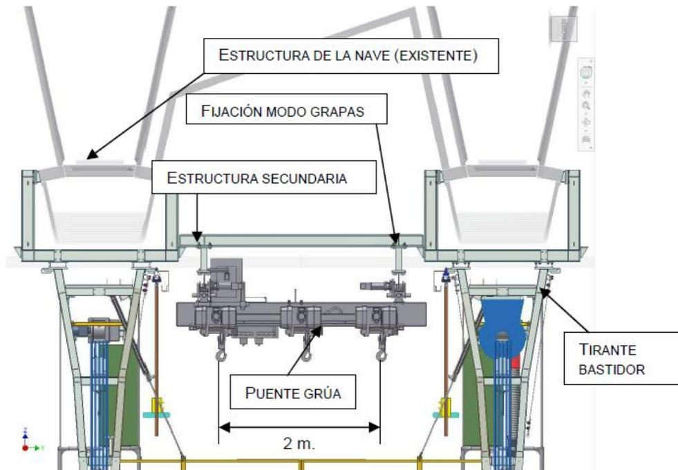
Figura 15 (ejemplo puente grúa en cochera Triangle)
