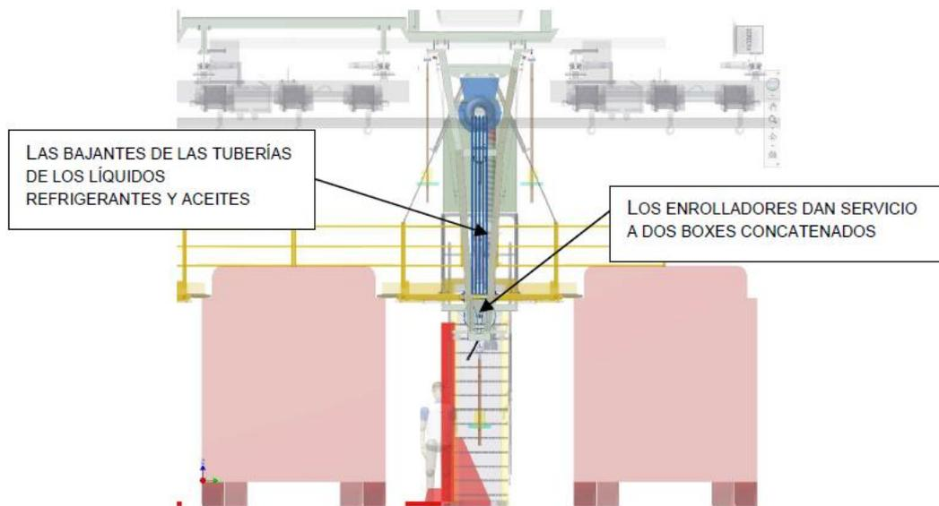
Figura 14 (ejemplo ubicación enrollador en cochera Triangle)
