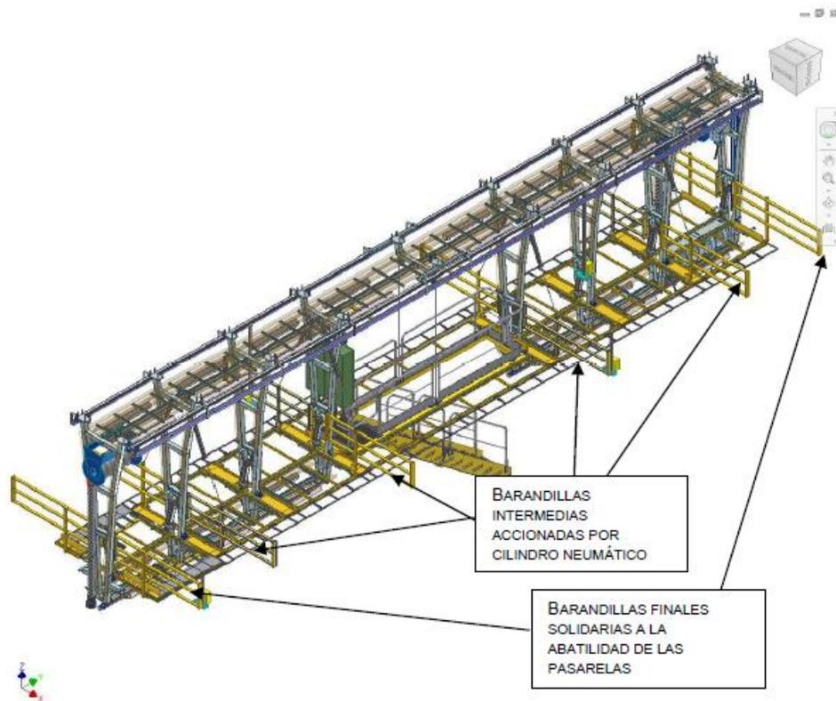
Figura 7 (ejemplo barandillas cochera Triangle)
