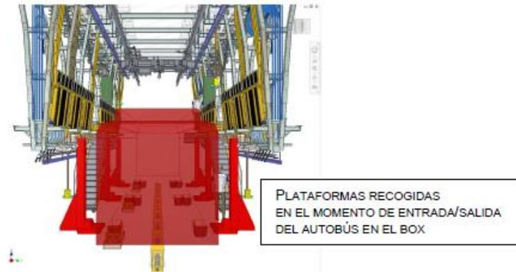
Figura 4 (ejemplo recogidas cochera Triangle para entrada y salida vehículo)
