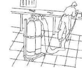
Les ampolles de oxigen i gas combustible han de estar en posició vertical i subjectat amb cadenes
