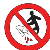
PROHIBIT TREPITJAR SÒL NO SEGUR
