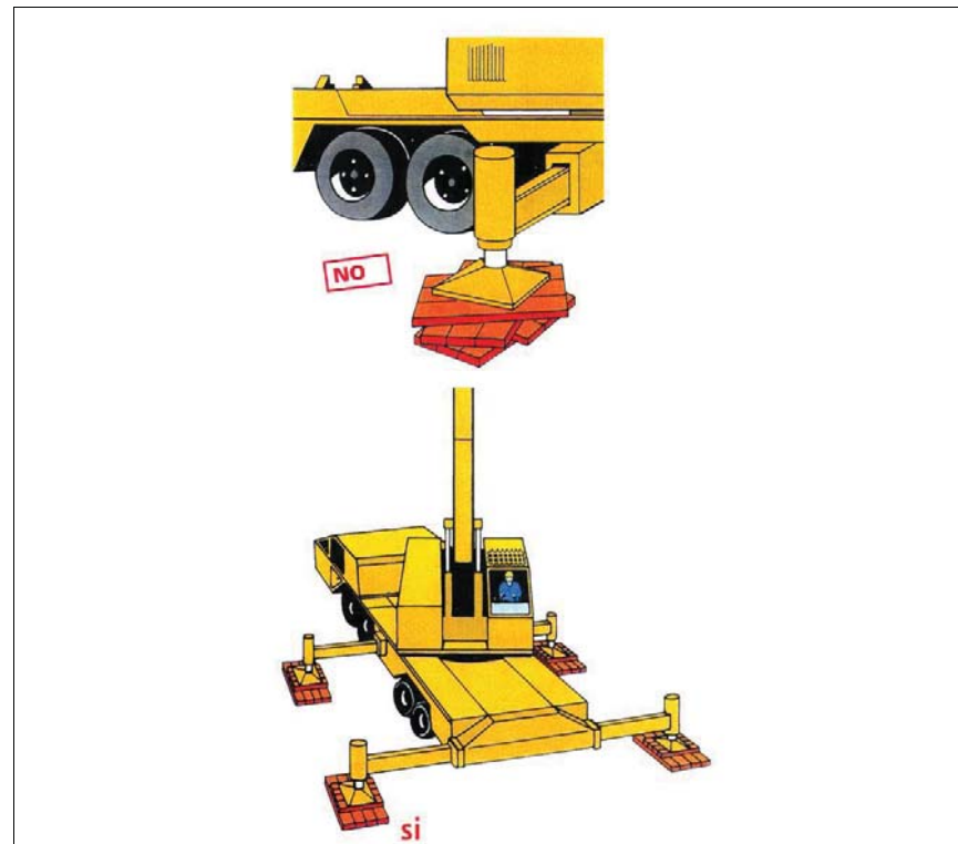
Col·locació estabilitzadors recolçaments
