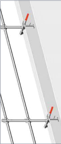
Ejemplo de aplicación de la mordaza para forjados en petos.
